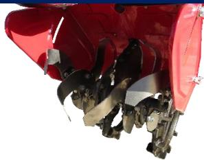
加工を施したステンレス製爪を採用。錆びにくく丈夫な設計です。
