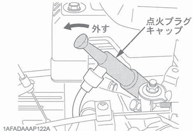
2. 付属のプラグボックスでプラグを外して、電極に付着したカーボンを取り除き、紙ヤスリでみがきます。
