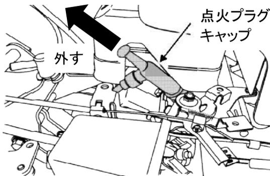
2. 付属のプラグボックスでプラグを外して、電極に付着したカーボンを取り除き、紙ヤスリでみがきます。
