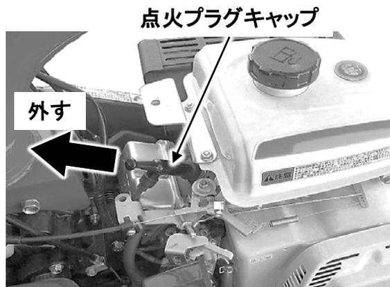
3. 付属のプラグボックスでプラグを外して、電極に付着したカーボンを取り除き、紙ヤスリでみがきます。
