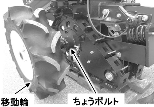
4. 移動輪を丸穴に合うところまで回して、機体から取りはずします。
